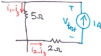
$$\begin{aligned} V_{test} &= 5\Omega \times (i_1 - i_3) + 2\Omega (i_2 - i_3) \\ &= 5\Omega (0 - (-1)) + 2\Omega (-1 - (-1)) \\ &= 5 \times 1 = 5V \end{aligned}$$
