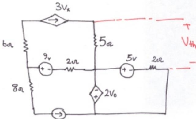
$$\text{at mesh 1: } \begin{cases} i_1 = 3V_x \\ V_x = 2\Omega \times i_3 \end{cases} \Rightarrow i_1 = 6i_3 \quad (\text{eq. 1})$$
