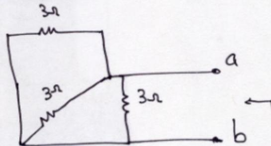
$$R_{th} = 3\Omega \parallel 3\Omega \parallel 3\Omega$$
