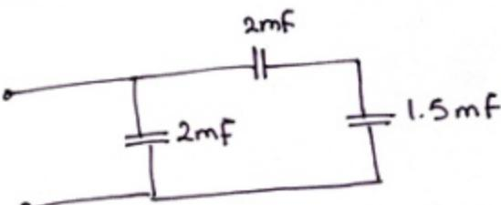
$$\frac{2\text{mF} \times 1.5\text{mF}}{2\text{mF} + 1.5\text{mF}} = \frac{6}{7} \text{ mF}$$
