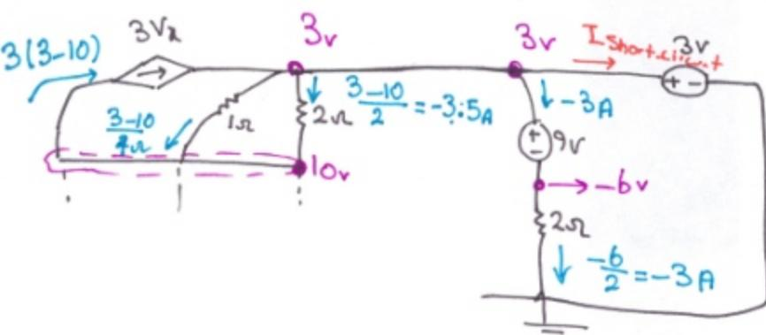
$$3(3-10)V - \frac{(3-10)V}{2\Omega} - \frac{(3-10)V}{1\Omega} - \left(\frac{-6V}{2\Omega}\right) - I_{\text{short-circuit}} = 0$$
