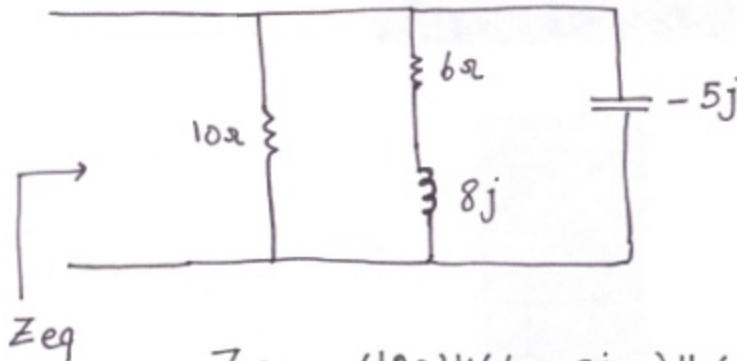
$$Z_{eq} = (10\Omega) \parallel (6\Omega + 8j\Omega) \parallel (-5j\Omega)$$
