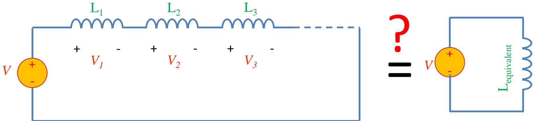
KVL  $V = V_1 + V_2 + \dots + V_n$
