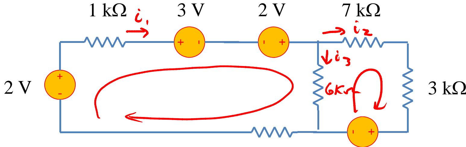
$$-2V + i_1 \cdot 1k\Omega + 3V - 2V + 6k\Omega i_3 + 2k\Omega i_1 = 0$$
