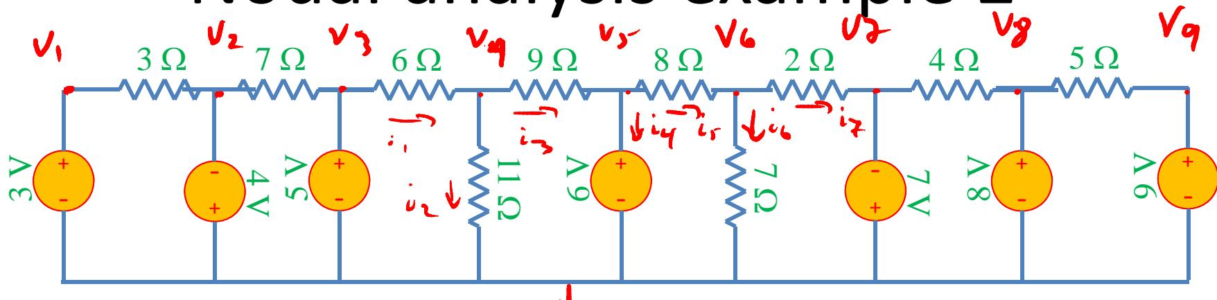
$$v_1 = 3V \quad v_2 = -4V \quad v_3 = 5V \quad v_4 = ???$$
