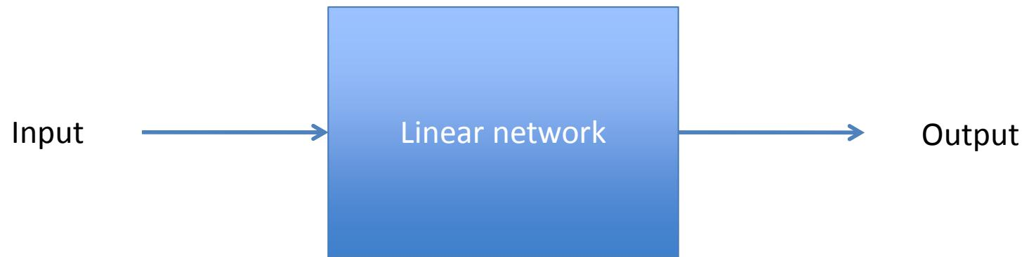
$$H(\omega) = V_{\text{out}} / V_{\text{in}}$$
