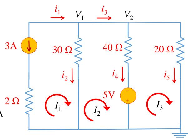
$$V_1 = V_2 = i_2 \times 30\Omega = i_4 \times 40\Omega - 5V = i_5 \times 20\Omega = -28.8V$$
